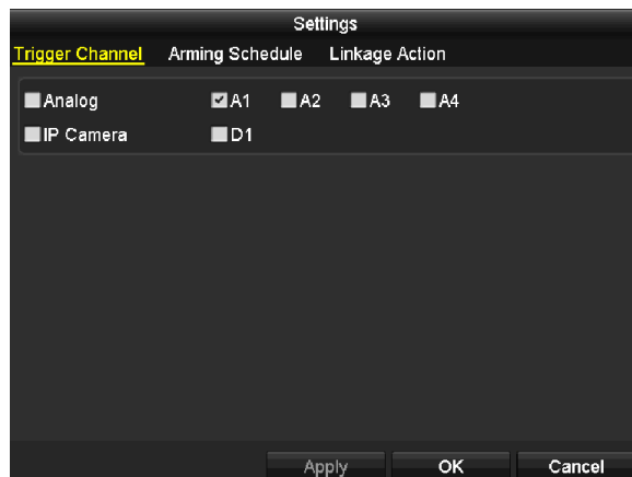
Figure 8. 15 Ustawianie kanału wyzwalanego dla alarmów VCA
