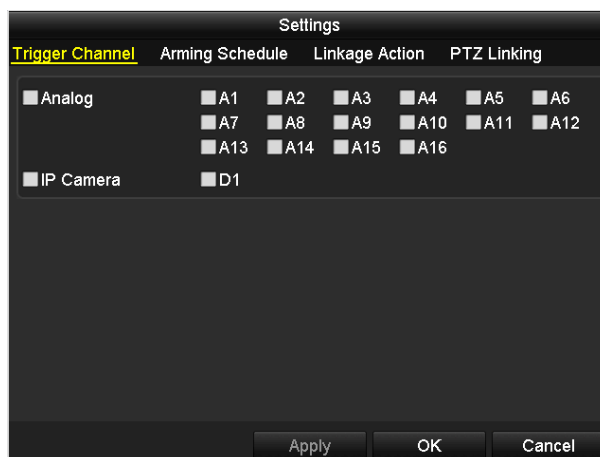
Figure 5. 20 Ustawianie wyzwalanej kamery alarmu VCA
