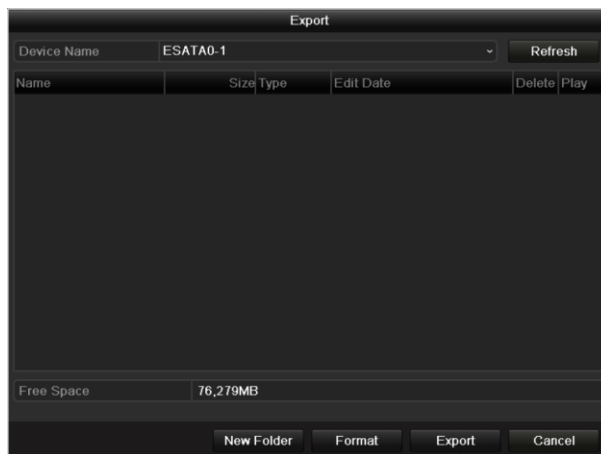
Figure 7. 6 Eksport na podstawie normalnego wyszukiwania wideo, przy użyciu dysku twardego eSATA
