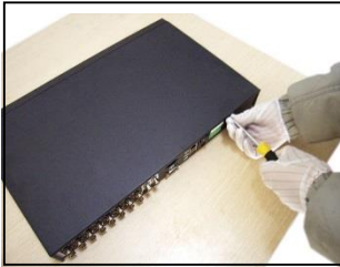
① Odkręcić śrubki obudowy
