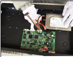
⑤ podłączyć przewody sygnałowe
