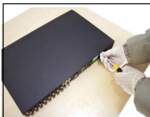
① Odkręcić śrubki obudowy
