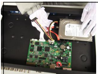
⑤ podłączyć przewody sygnałowe
