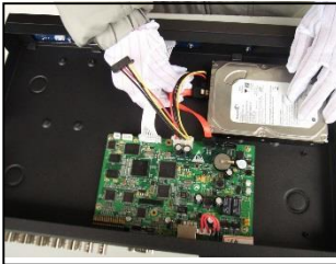
⑤ podłączyć przewody sygnałowe
